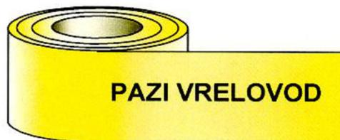
U cilju sprečavanja oštećenja cjevovoda u rov u koji se polaže cjevovod postavlja se traka upozorenja sa natpisom »PAŽNJA TOPLOVOD« ili »PAŽNJA VRELOVOD« ili natpis za upozorenja za drugu instalaciju. Traka za upozorenje je žute, a boje isporučuje se u kolutu širine 40mm. Postavljanje trake vrši se na dubinu od 200 mm ispod gornjeg sloja površine zemlje sa kojima se vrši zatrpavanje kanala nakon montaže cjevovoda.
